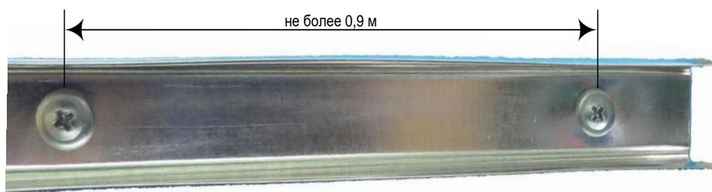
Рис. 56. Пример крепления кабель-канала металлического огнестойкого.
